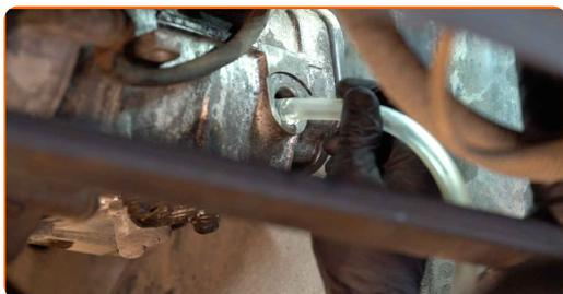
**13** Füllen Sie durch die Einfüllöffnung das Öl in das Getriebe.
