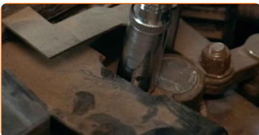
**4** Entfernen Sie die Batterieklammern.
