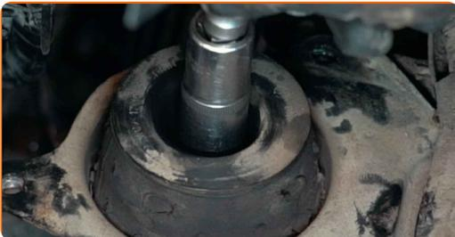
**74** Ziehen Sie die Befestigungen an, die das Getriebelager mit der Karosserie verbinden. Verwenden Sie Stecknuss Nr. 13. Verwenden Sie einen Drehmomentschlüssel. Ziehen Sie ihn mit 38 Nm Drehmoment fest.
