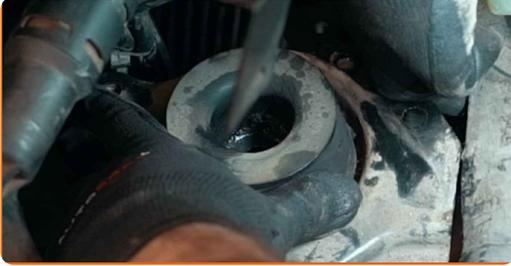
**73** Schrauben Sie die Befestigungen an, die das Getriebelager mit der Karosserie verbinden. Verwenden Sie Stecknuss Nr. 18. Verwenden Sie einen Ratschenschlüssel.
