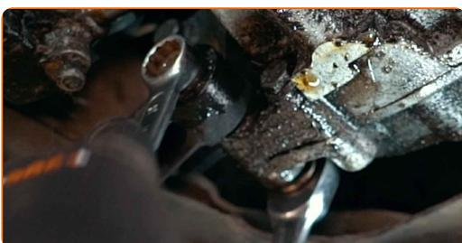
**37** Reinigen Sie die Befestigungen des Getriebelagers. Benutzen Sie eine Drahtbürste. Benutzen Sie WD-40-Spray.
