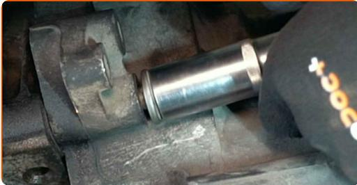
**68** Ziehen Sie die Befestigungen, die das Getriebe mit dem Motorblock verbinden, an. Verwenden Sie Stecknuss Nr. 18. Verwenden Sie einen Drehmomentschlüssel. Ziehen Sie ihn mit 64 Nm Drehmoment fest.
