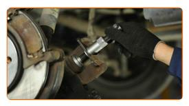
36.1 Installieren Sie den Bremssattel und fixieren Sie diesen.
