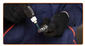
Setzen Sie die Halterung des Bremssattels ein.
