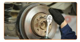
19 Entfernen Sie die Bremsscheibe.
