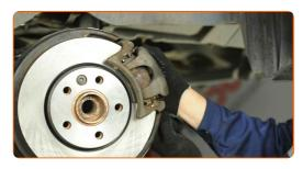
Verwenden Sie Stecknuss Nr. 12. Verwenden Sie einen Drehmomentschlüssel. Ziehen Sie ihn mit 30 Nm Drehmoment fest.
