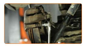
yerteilen Sie die Bremsbeläge. Benutzen Sie ein Brecheisen.
