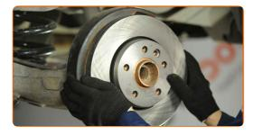
Ziehen Sie die Befestigung der Bremsscheibe fest. Verwenden Sie den Torx M10. Verwenden Sie einen Drehmomentschlüssel. Ziehen Sie ihn mit 15 Nm Drehmoment fest.
