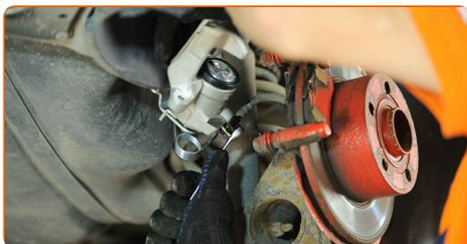
**17** Installieren Sie den Bremssattel und fixieren Sie diesen.
