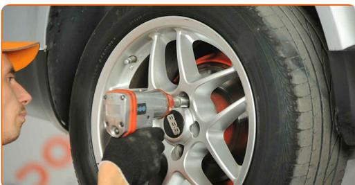
**29** Senken Sie das Auto und ziehen Sie die Radschrauben über Kreuz an. Verwenden Sie einen Drehmomentschlüssel. Ziehen Sie ihn mit 120 Nm Drehmoment fest.
