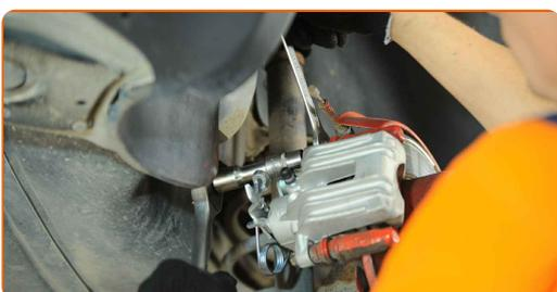
**19** Das Kabel der Feststellbremse in die Bremssattelhalterung einbauen. Verwenden Sie einen flachen Schraubendreher.
