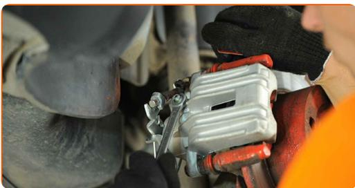
**Austausch: Bremssattel – VW PASSAT (32B). Tipp von AUTODOC:**
