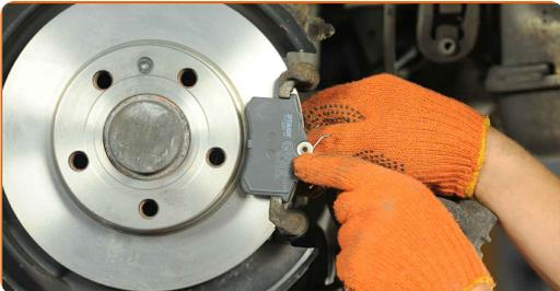
**Austausch: Bremsbeläge – VW PASSAT (32B). AUTODOC-Experten empfehlen:**
