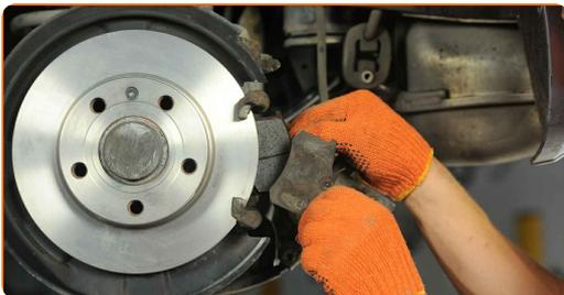
**Austausch: Bremsbeläge – VW PASSAT (32B). Tipp:**
