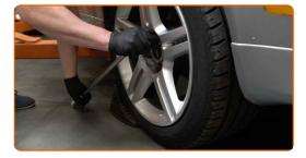
Drehen Sie das Befestigungselement der Antriebswelle auf. Verwenden Sie Inbusschlüssel Nr. H17. Verwenden Sie ein Windeisen.
