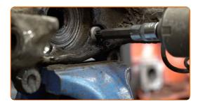
Entfernen Sie die Radnabe vom Achsschenkel.
