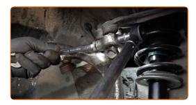
Behandeln Sie alle Gelenke des Querlenkers. Behandeln Sie die Befestigungen des Kugelgelenks. Behandeln Sie das Befestigungselement, das den Spurstangenkopf mit dem Achsschenkel verbindet. Benutzen Sie ein Kupferschmiermittel.
