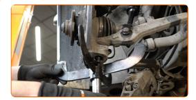
Ziehen Sie den Spurstangenkopf vom Achsschenkel. Verwenden Sie einen flachen Metallmeißel. Benutzen Sie einen Hammer.
