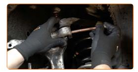
Schrauben Sie die Befestigungen der oberen Querlenker ein. Verwenden Sie Ring-Gabelschlüssel Nr. 16 (2 Teile).
