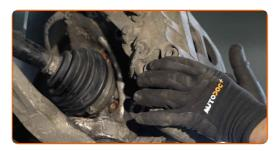
Befestigen Sie die Bremssattelhalterung. Verwenden Sie Stecknuss Nr. 21. Verwenden Sie einen Drehmomentschlüssel. Ziehen Sie ihn mit 190 Nm Drehmoment fest.
