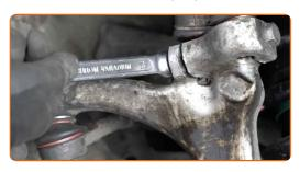
Entfernen Sie die Befestigungsschraube.
