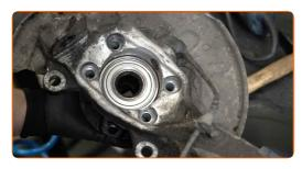
Ziehen Sie die Nabe hindurch. Benutzen Sie den XZN #12. Verwenden Sie einen Drehmomentschlüssel. Ziehen Sie ihn mit 80 Nm Drehmoment fest.+90°
