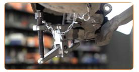
Lösen Sie den Querlenker.
