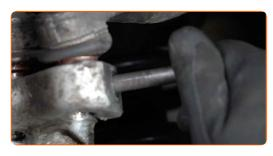
29 Entfernen Sie die Querlenker.
