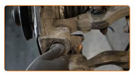
Verbinden Sie das Kugelgelenk mit dem Achsschenkel.
