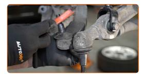
Installieren Sie den Achsschenkel mit einer Nabe.
