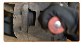
Die Befestigungselemente der Bremssattelhalterung reinigen. Benutzen Sie eine Drahtbürste. Benutzen Sie WD-40-Spray.
