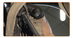
Ziehen Sie das Kugelgelenk an. Verwenden Sie Stecknuss Nr. 18. Verwenden Sie einen Drehmomentschlüssel. Ziehen Sie ihn mit 110 Nm Drehmoment fest.
