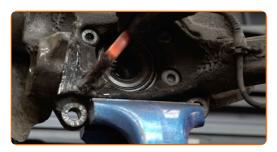
Schrauben Sie die Radnaben-Achsmutter ab. Benutzen Sie den XZN #12. Verwenden Sie einen Ratschenschlüssel.
