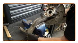
Behandeln Sie den Befestigungssitz der Radnabe. Benutzen Sie eine Drahtbürste. Benutzen Sie WD-40-Spray.
