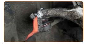
Lockern Sie die Befestigungsschraube des Spurstangenkopfs. Verwenden Sie Stecknuss Nr. 13. Verwenden Sie einen Ratschenschlüssel.
