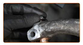
Schrauben Sie die Befestigungsschraube des Spurstangenkopfs ein. Verwenden Sie Ring-Gabelschlüssel Nr. 13.
