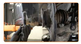
Reinigen Sie die Befestigung des ABS-Sensors. Verwenden Sie eine Nylon-Reinigungsbürste. Verwenden Sie Allzweckreinigungsspray.
