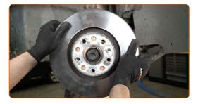
Ziehen Sie die Befestigung der Bremsscheibe fest. Verwenden Sie den Torx T30. Verwenden Sie einen Drehmomentschlüssel. Ziehen Sie ihn mit 5 Nm Drehmoment fest.
