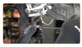
Lösen Sie den Querlenker.
