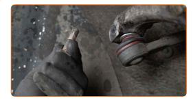
34 Stützen Sie die Achsschenkel auf. Benutzen Sie einen hydraulischen Getriebeheber.
