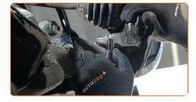
Trennen Sie das Kugelgelenk vom Achsschenkel. Verwenden Sie einen Kugelgelenkabzieher.
