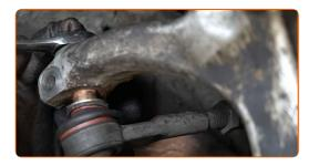
Schrauben Sie die Befestigungsmutter auf, die den Spurstangenkopf mit dem Achsschenkel verbindet. Verwenden Sie Stecknuss Nr. 15. Verwenden Sie einen Ratschenschlüssel.
