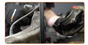
Entfernen Sie die Nabenlagerhalterung. Verwenden Sie einen Universalabzieher.
