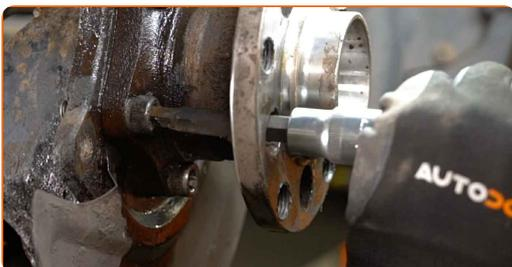
**19** Entfernen Sie die Nabe und das Lager zusammen, da sie eine versiegelte Einheit sind.
