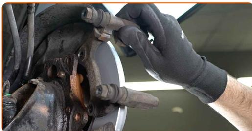
**30** Befestigen Sie die Bremssattelhalterung. Verwenden Sie Inbusschlüssel Nr. H8. Verwenden Sie einen Drehmomentschlüssel. Ziehen Sie ihn mit 95 Nm Drehmoment fest.
