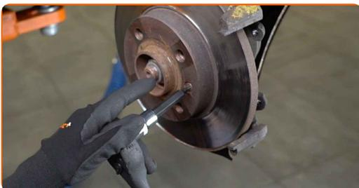
**15** Entfernen Sie die Bremsscheibe.
