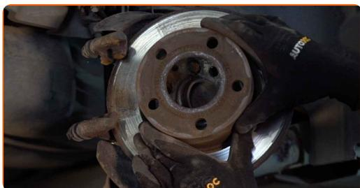
**12** Säubern Sie die Halterung des Bremssattels. Benutzen Sie eine Drahtbürste. Benutzen Sie einen Bremsenreiniger.
