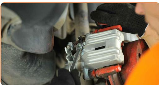
**Austausch: Bremssattel – VW Passat CC (357). Tipp von AUTODOC:**
