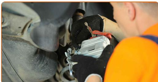
**20** Sichern Sie das Feststellbremskabel mit der Halteklammer. Verwenden Sie einen flachen Schraubendreher.
