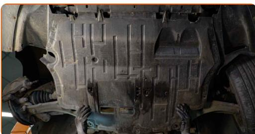
**33** Ziehen Sie die Befestigungen der unteren Ölwanne-Abdeckung fest. Verwenden Sie Stecknuss Nr. 13. Verwenden Sie den Torx T25. Verwenden Sie einen Ratschenschlüssel.
