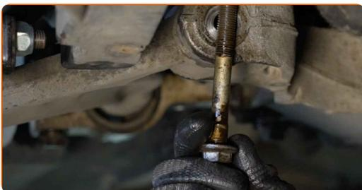
**16** Entfernen Sie den Arm. Benutzen Sie ein Brecheisen.
