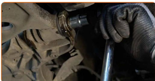
**10** Schrauben Sie das hintere Befestigungselement heraus, das den Querlenker mit der Karosserie verbindet. Verwenden Sie Stecknuss Nr. 18. Verwenden Sie ein Windeisen.
