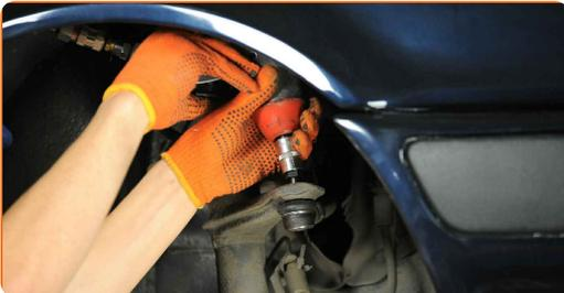
**16** Ziehen Sie die Spurstangenkopf Sicherungsmutter an. Verwenden Sie Ring-Gabelschlüssel Nr. 14. Verwenden Sie Ring-Gabelschlüssel Nr. 22. Verwenden Sie einen Drehmomentschlüssel. Ziehen Sie ihn mit 40 Nm Drehmoment fest.
