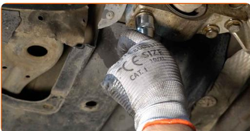
**11** Schrauben Sie das hintere Befestigungselement heraus, das den Querlenker mit dem Hilfsrahmen verbindet. Verwenden Sie Stecknuss Nr. 16. Verwenden Sie ein Windeisen.
