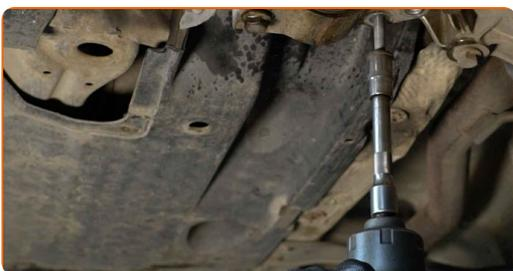
**15** Lösen Sie die hintere Befestigung des Querlenkers.
