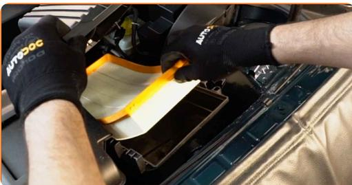
**9** Bedecken Sie den Luftansaugschlauch mit einem Mikrofaser Tuch, um zu vermeiden, dass Staub und Schmutz in das System gelangen.
