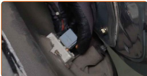
**62** Stecken Sie den Stecker des Fensterheberschaltermoduls ein.
