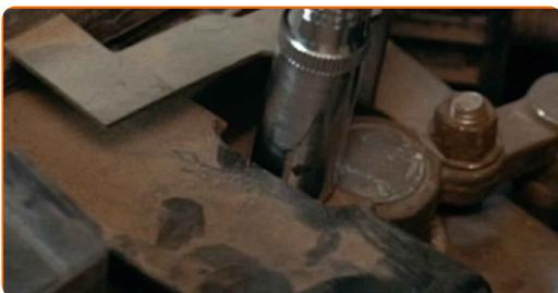
**4** Entfernen Sie die Batterieklemmen.
