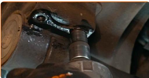
**39** Entfernen Sie das Getriebelager.
