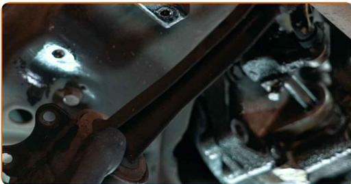
**40** Stützen Sie das Getriebe unter. Benutzen Sie einen hydraulischen Getriebeheber.
