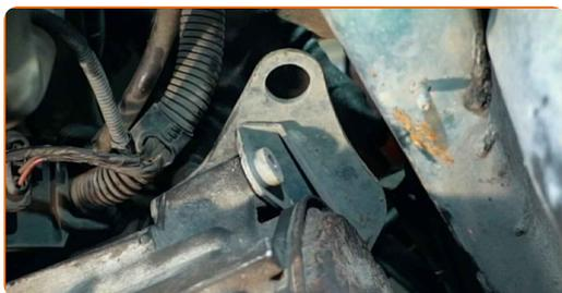
**70** Schrauben Sie die Befestigungen an, die das Getriebelager mit dem Getriebe verbinden. Verwenden Sie Ring-Gabelschlüssel Nr. 16.
