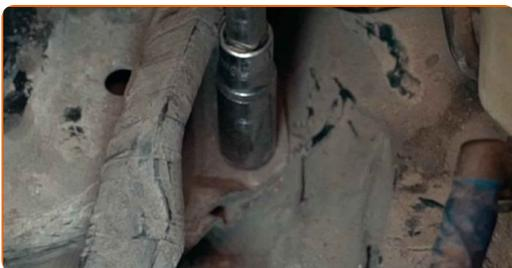
**75** Ziehen Sie die Befestigungen an, die das Getriebelager mit dem Getriebe verbinden. Verwenden Sie Stecknuss Nr. 18. Verwenden Sie einen Drehmomentschlüssel. Ziehen Sie ihn mit 69 Nm Drehmoment fest.
