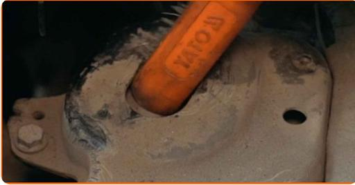
**42** Schrauben Sie die Befestigungen des Getriebelagers ab. Verwenden Sie Stecknuss Nr. 18. Verwenden Sie einen Ratschenschlüssel.
