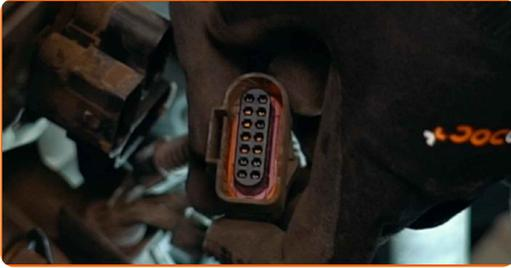
11 Lösen Sie den Motorkabelbaum.
