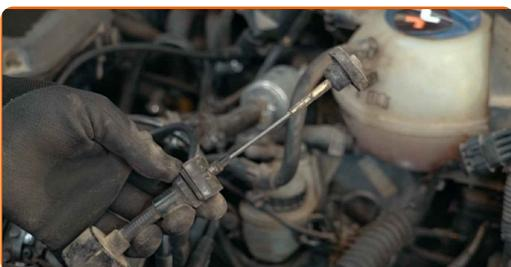
10 Trennen Sie den Steckverbinder des Motorkabelbaums.
