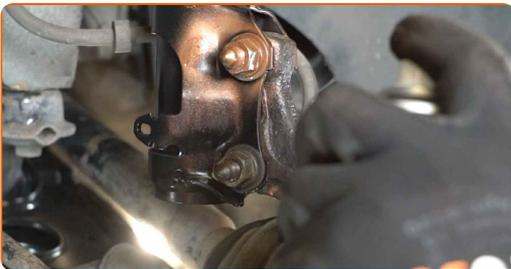
**43** Reinigen Sie die Oberfläche an welcher die Felge montiert werden soll. Benutzen Sie eine Drahtbürste.
