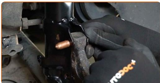
**36** Schrauben Sie die Befestigungen ein, die das Federbein mit dem Achsschenkel verbinden. Verwenden Sie Ring-Gabelschlüssel Nr. 18. Verwenden Sie Stecknuss Nr. 18. Verwenden Sie ein Windeisen.
