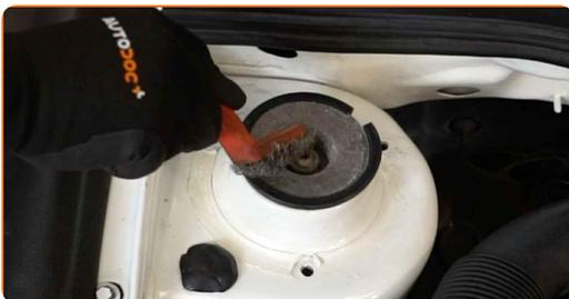
**4** Lösen Sie die oberen Befestigungselemente des Federbeinstützlagers. Verwenden Sie Inbusschlüssel Nr. H6. Verwenden Sie Stecknuss Nr. 21. Verwenden Sie einen Ratschenschlüssel.
