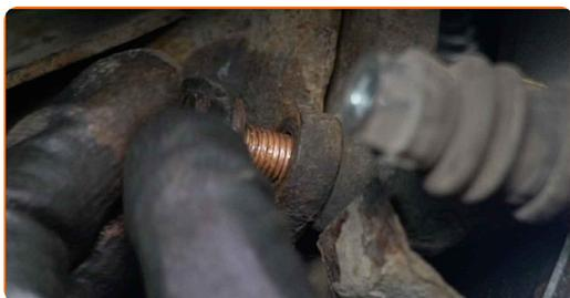
**41** Ziehen Sie die Befestigungen des Bremssattelhalters fest. Verwenden Sie Inbusschlüssel Nr. H8. Verwenden Sie einen Drehmomentschlüssel. Ziehen Sie ihn mit 65 Nm Drehmoment fest.
