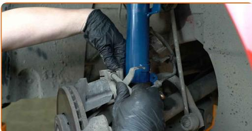
**65** Verbinden Sie das ABS mit der Sensorverdrahtung. Verwenden Sie eine Wasserpumpenzange.
