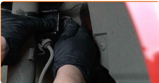
**15** Reinigen Sie die Halterung des ABS-Kabelbaums. Benutzen Sie eine Drahtbürste. Benutzen Sie WD-40-Spray.
