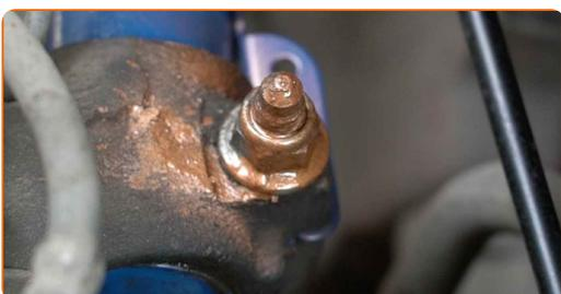
**69** Reinigen Sie die Oberfläche an welcher die Felge montiert werden soll. Benutzen Sie eine Drahtbürste.
