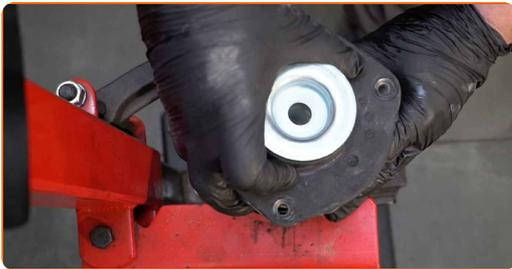
**42** Ziehen Sie die Federbeinbolzenmutter an. Verwenden Sie Inbusschlüssel Nr. H7. Verwenden Sie Stecknuss Nr. 21. Verwenden Sie einen Drehmomentschlüssel. Ziehen Sie ihn mit 60 Nm Drehmoment fest.
