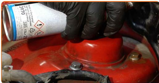
**78** Setzen Sie die Schutzkappe auf die Stoßdämpferstütze.
