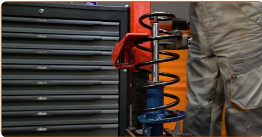
**41** Bringen Sie das Stützlager, die Manschette und den Anschlagpuffer auf dem Stoßdämpfer an.
