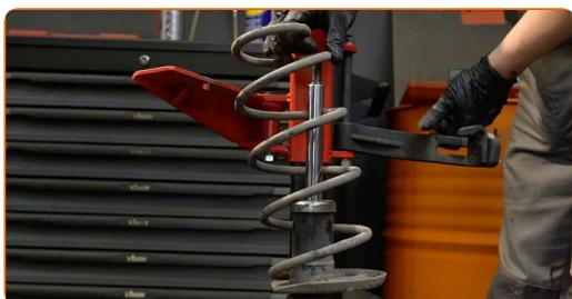
**39** Installieren Sie die Feder am Stoßdämpfer.
