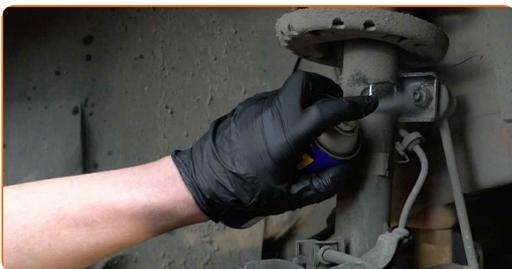
**13** Schrauben Sie das Befestigungselement heraus, das die Druckstange mit dem Federbein verbindet. Verwenden Sie Stecknuss Nr. 17. Verwenden Sie einen Ratschenschlüssel.
