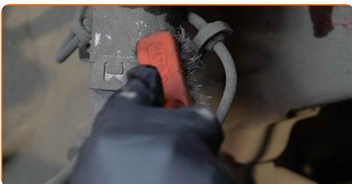
**16** Behandeln Sie die Halteklammer des Bremsschlauchs.
