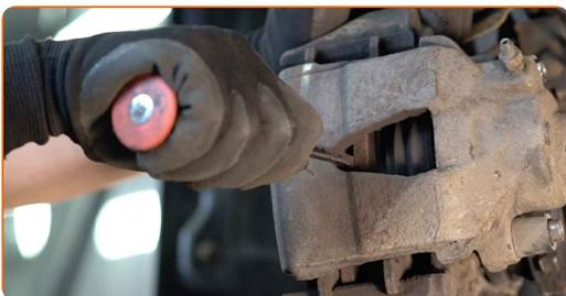
**12** Entfernen Sie den Bremssattel.
