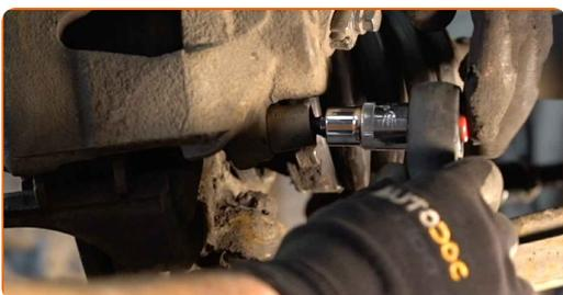
**11** Verteilen Sie die Bremsbeläge. Benutzen Sie ein Brechisen.
