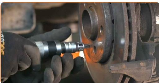
**15** Entfernen Sie die Bremsscheibe.
