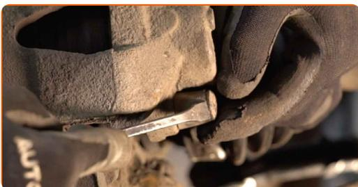
**10** Schrauben Sie die Befestigung des Bremssattels ab. Verwenden Sie Inbusschlüssel Nr. H7. Verwenden Sie einen Ratschenschlüssel.
