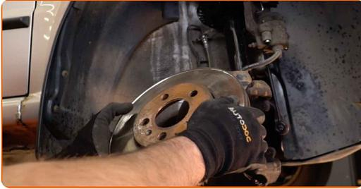
**16** Reinigen Sie die Nabe. Benutzen Sie eine Drahtbürste. Behandeln Sie die Kontaktfläche. Benutzen Sie ein Kupferschmiermittel.
