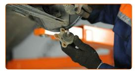
Reinigen Sie den Kugelgelenk-Montagesitz. Benutzen Sie eine Drahtbürste. Benutzen Sie WD-40-Spray.
