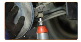
Behandeln Sie das Befestigungselement, das den Spurstangenkopf mit dem Achsschenkel verbindet. Behandeln Sie die Befestigungen des Kugelgelenks. Benutzen Sie ein Kupferschmiermittel.
