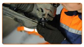
Ziehen Sie das Kugelgelenk an. Verwenden Sie Stecknuss Nr. 13. Verwenden Sie einen Drehmomentschlüssel. Ziehen Sie ihn mit 20 Nm Drehmoment fest.+90°
