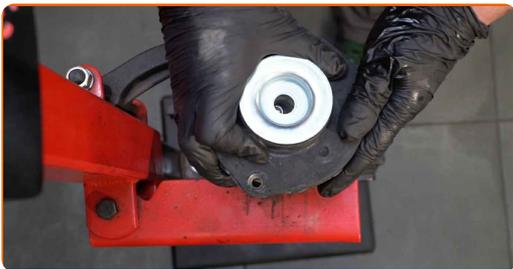
**39** Ziehen Sie die Federbeinkolbenstangenmutter an. Verwenden Sie Inbusschlüssel Nr. H7. Verwenden Sie Stecknuss Nr. 21. Verwenden Sie einen Drehmomentschlüssel.
