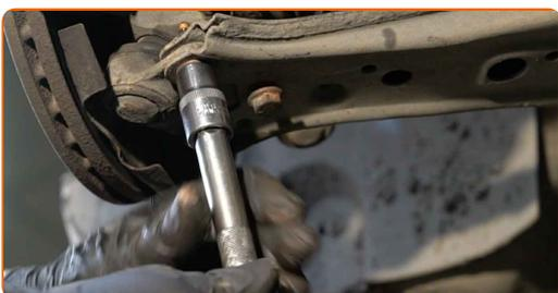
**55** Ziehen Sie das Kugelgelenk an. Verwenden Sie Stecknuss Nr. 13. Verwenden Sie einen Drehmomentschlüssel. Ziehen Sie ihn mit 20 Nm Drehmoment fest.+90°
