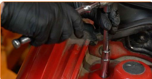
**5** Entfernen Sie die Schutzkappe von der Stoßdämpferstütze.
