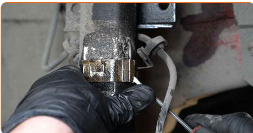
**18** Trennen Sie den Bremsschlauch. Benutzen Sie ein Brecheisen.
