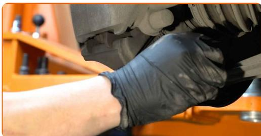
**25** Lösen Sie das Befestigungselement, welches die Antriebswelle mit der Radnabe verbindet. Verwenden Sie Stecknuss Nr. 36.
