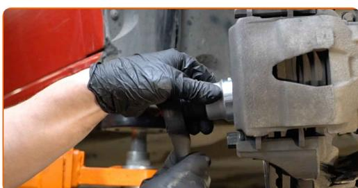
**26** Trennen Sie die Antriebswelle vom Achsschenkel. Verwenden Sie einen Splintentreiber. Benutzen Sie einen Hammer.
