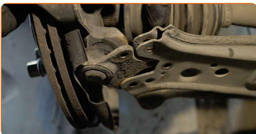
**53** Verbinden Sie das Kugelgelenk mit dem Lenker.
