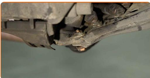
**54** Schrauben Sie die Befestigungen des Kugelgelenks ein. Verwenden Sie Stecknuss Nr. 13. Verwenden Sie einen Ratschenschlüssel.
