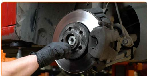
**12** Verwenden Sie Stecknuss Nr. 36. Verwenden Sie ein Windeisen.
