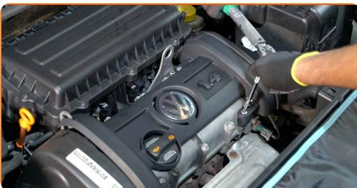
16 Verbinden Sie den Entlüftungsschlauch.
