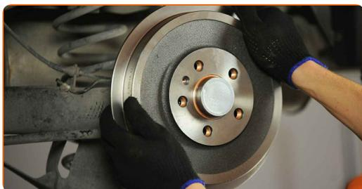
**25** Ziehen Sie die Halteklammern der Bremstrommeln an. Verwenden Sie den Torx T30. Verwenden Sie einen Drehmomentschlüssel. Ziehen Sie ihn mit 4 Nm Drehmoment fest.
