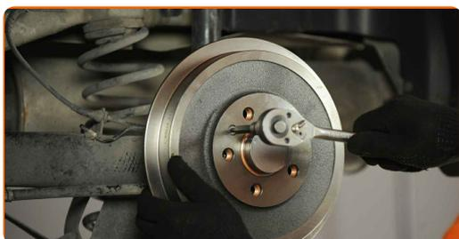
**26** Reinigen Sie die Oberfläche an welcher die Felge montiert werden soll. Benutzen Sie eine Drahtbürste.
