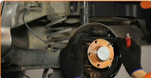
**21** Bauen Sie die untere Rückstellfeder ein. Verwenden Sie Zangen.
