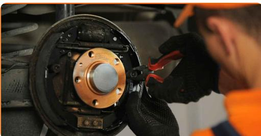
**23** Reinigen Sie die Nabe. Benutzen Sie eine Drahtbürste. Behandeln Sie die Kontaktfläche. Benutzen Sie ein Kupferschmiermittel.
