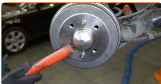
**27** Behandeln Sie die Oberfläche, an der die Radfelge die Bremstrommel berührt. Verwenden Sie Hochtemperatur-Keramikfett.
