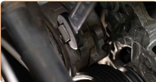
**5** Entfernen Sie den Keilrippenriemen.
