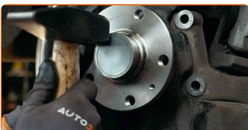
**29** Behandeln Sie die Radnabe an der Kontaktstelle mit der Bremsscheibe. Benutzen Sie ein Kupferschmiermittel.
