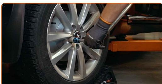
**40** Entfernen Sie den Wagenheber sowie die Unterlegkeile.
