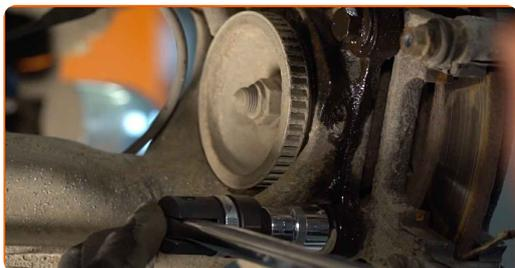
**16** Entfernen Sie die Sattelhalterung.
