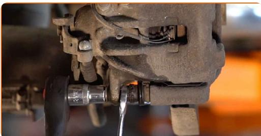
**10** Trennen Sie den Stecker der Verschleißsensoren des Bremsbelags.
