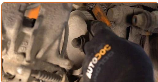
**15** Lösen Sie die Befestigung der Sattelhalterung. Verwenden Sie Stecknuss Nr. 18. Verwenden Sie einen Ratschenschlüssel. Verwenden Sie ein Windeisen.
