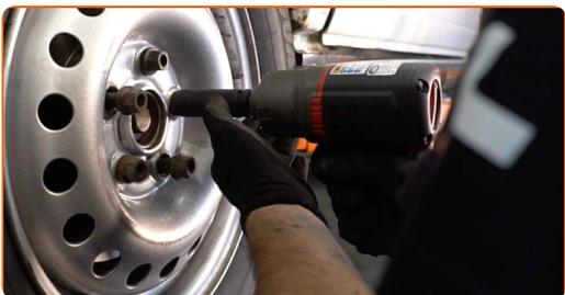
**35** Senken Sie das Auto und ziehen Sie die Radschrauben über Kreuz an. Verwenden Sie einen Drehmomentschlüssel. Ziehen Sie ihn mit 170 Nm Drehmoment fest.
