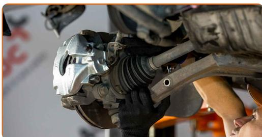
**9** Entfernen Sie die Befestigungsschraube. Verwenden Sie einen Splintentreiber. Benutzen Sie einen Hammer.
