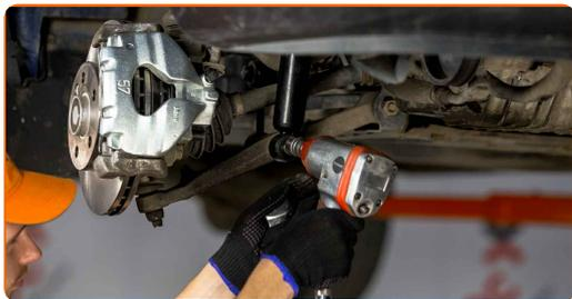
**8.2** Verwenden Sie Ring-Gabelschlüssel Nr. 21. Verwenden Sie Stecknuss Nr. 21. Verwenden Sie einen Ratschenschlüssel.
