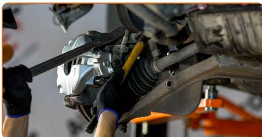
**10** Lösen Sie die obere Befestigung des Federbeins. Verwenden Sie Stecknuss Nr. 18. Verwenden Sie einen Ratschenschlüssel.
