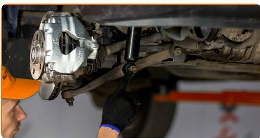
**8** Schrauben Sie die Befestigungen heraus, die das Federbein mit dem Aufhängungs-Querlenker verbinden.
