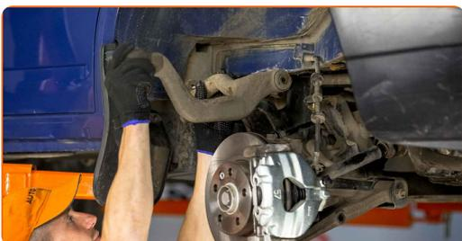
**26** Reinigen Sie die Montagebohrungen und die Gewinde des Querlenkers. Benutzen Sie eine Drahtbürste. Benutzen Sie WD-40-Spray.
