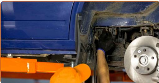
**35** Ziehen Sie die oberen Befestigungsschrauben an (2 Stück). Verwenden Sie Ring-Gabelschlüssel Nr. 21. Verwenden Sie Stecknuss Nr. 21. Verwenden Sie einen Drehmomentschlüssel. Ziehen Sie ihn mit 160 Nm Drehmoment fest.
