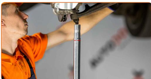
**30** Ziehen Sie die Hilfsrahmenbefestigung ab. Verwenden Sie Stecknuss Nr. 21. Verwenden Sie einen Ratschenschlüssel.
