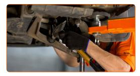
Ziehen Sie das Befestigungselement an, das das Federbein mit dem Aufhängungs-Querlenker verbindet. Verwenden Sie Stecknuss Nr. 21. Verwenden Sie einen Drehmomentschlüssel. Ziehen Sie ihn mit 160 Nm Drehmoment fest.
