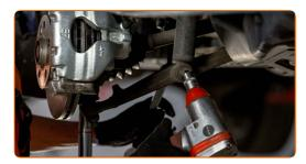
15 Entfernen Sie den Träger unter dem Arm.
