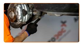
Schrauben Sie die Befestigungen heraus, die das Federbein mit dem Aufhängungs-Querlenker verbinden. Verwenden Sie Ring-Gabelschlüssel Nr. 21. Verwenden Sie Stecknuss Nr. 21. Verwenden Sie einen Ratschenschlüssel.
