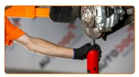
Entfernen Sie die Befestigungsschraube. Verwenden Sie einen Splintentreiber. Benutzen Sie einen Hammer.
