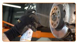
Die Bremsscheibenoberfläche reinigen. Benutzen Sie einen Bremsenreiniger.
