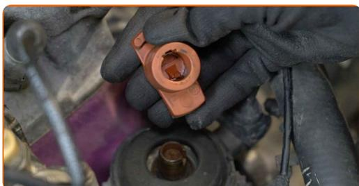
**Austausch: Verteilerfinger – VW Transporter T3 Kastenwagen. Fachleute empfehlen:**
