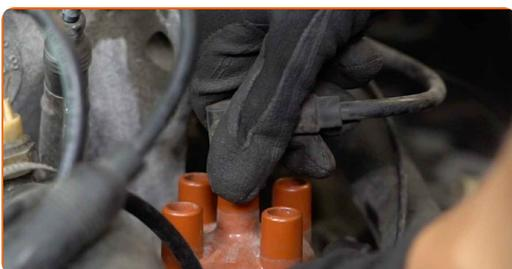
**Austausch: Verteilerfinger – VW Transporter T3 Kastenwagen. Tipp von AUTODOC:**
