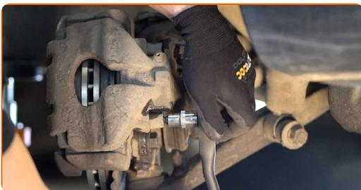
**29** Installieren Sie die Staubschutzkappen der Bremssattel-Führungsstifte.
