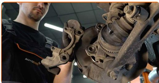
**16** Die Bremsscheibenoberfläche reinigen. Benutzen Sie eine Drahtbürste. Benutzen Sie WD-40-Spray.
