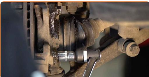
**15** Entfernen Sie die Sattelhalterung.
