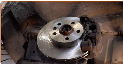
Austausch: Bremsscheiben – VW Transporter T4 Pritsche / Fahrgestell (70E, 70L, 70M, 7DE, 7DL, 7D). AUTODOC-Experten empfehlen:
