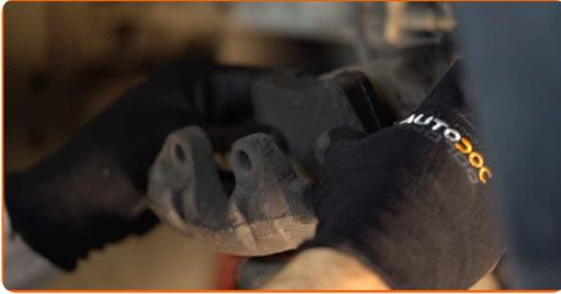
**28** Installieren Sie den Bremssattel und fixieren Sie diesen. Verwenden Sie Inbusschlüssel Nr. H7. Verwenden Sie einen Drehmomentschlüssel. Ziehen Sie ihn mit 35 Nm Drehmoment fest.
