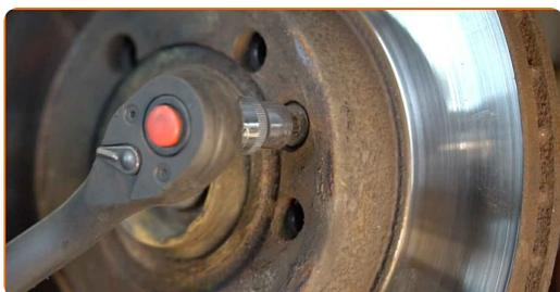
Austausch: Bremsscheiben – VW Transporter T4 Pritsche / Fahrgestell (70E, 70L, 70M, 7DE, 7DL, 7D). AUTODOC empfiehlt:
