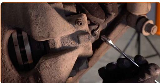
**19** Bringen Sie den Bremsschlauch an der Haltevorrichtung an. Befestigen Sie den neuen Bremsschlauch.
