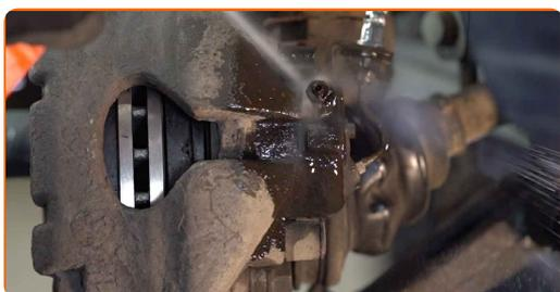
Austausch: Bremsschläuche – VW Transporter T4 Pritsche / Fahrgestell (70E, 70L, 70M, 7DE, 7DL, 7D). Tipp von AUTODOC-Experten:
