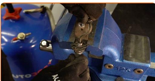
**16** Lockern Sie den Schraubstock und entfernen Sie die Haltevorrichtung des Bremsschlauchs.
