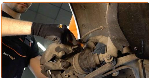
**Austausch: Bremsschläuche – VW Transporter T4 Pritsche / Fahrgestell (70E, 70L, 70M, 7DE, 7DL, 7D). Fachleute empfehlen:**
