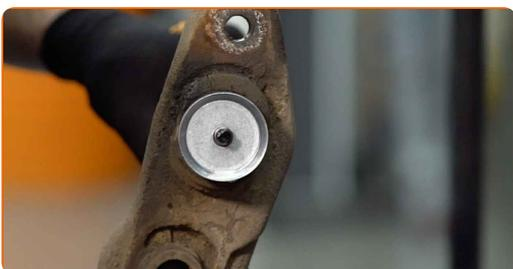
**19** Reinigen Sie die Stoßdämpferstange. Benutzen Sie WD-40-Spray.
