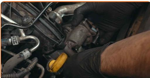
56 Machen Sie die Befestigungen der Drosselklappe am Luftansaugkrümmer fest. Verwenden Sie den Torx T27. Verwenden Sie einen Drehmomentschlüssel. Ziehen Sie ihn mit 14 Nm Drehmoment fest.
