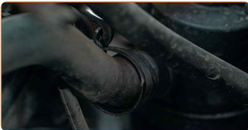
29 Lösen Sie den oberen Kühlmittelschlauch.
