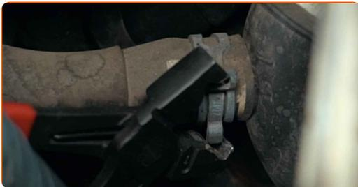
27 Lösen Sie den oberen Kühlmittelschlauch.
