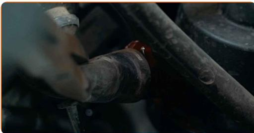
Austausch: Thermostat – VW Transporter T6 Kastenwagen (SGA, SGH). Tipp:
