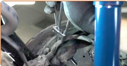
**14** Schrauben Sie den Bremsschlauch vom Bremssattel ab. Verwenden Sie Ring-Gabelschlüssel Nr. 14.
