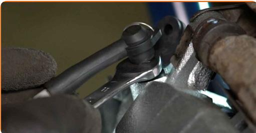
**29** Trennen Sie den Schlauch des Bremsentlüftungs-Kits.
