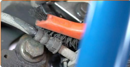
**13** Klemmen Sie den Bremsschlauch ab, indem Sie eine geeignete Klemme einsetzen.
