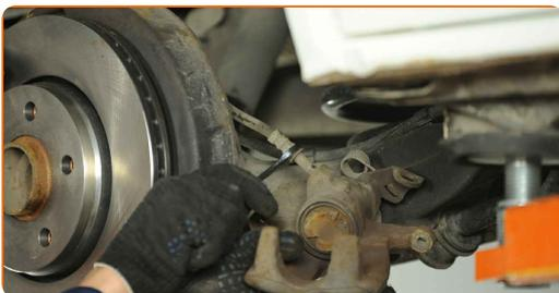
**16** Installieren und fixieren Sie den Bremsschlauch in einen neuen Bremssattel.
