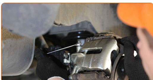
**27** Entlüften Sie das Bremssattelsystem.
