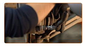
10 Entfernen Sie den Bremssattel.
