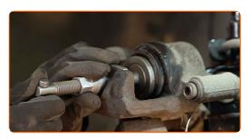
Behandeln Sie den Bremssattelhalter dort, wo er die Bremsbeläge berührt. Benutzen Sie eine Anti-Quietsch-Paste.
