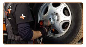
Senken Sie das Auto und ziehen Sie die Radschrauben über Kreuz an. Verwenden Sie einen Drehmomentschlüssel. Ziehen Sie ihn mit 175 Nm Drehmoment fest.
