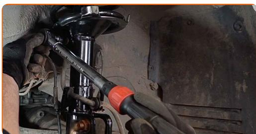
**12** Ziehen Sie das Befestigungselement an, das die Druckstange mit dem Stabilisator verbindet. Verwenden Sie Stecknuss Nr. 16. Verwenden Sie Ring-Gabelschlüssel Nr. 16. Verwenden Sie einen Drehmomentschlüssel. Ziehen Sie ihn mit 62 Nm Drehmoment fest.
