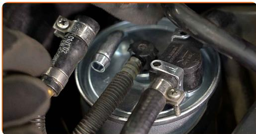
**14** Befestigen Sie die Leitung am Kraftstofffilter.
