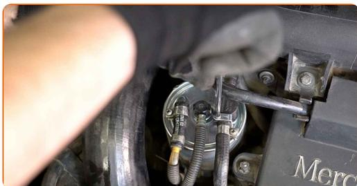
**16** Ziehen Sie die Befestigungsklemme der Kraftstoffversorgungsleitung an. Verwenden Sie einen Kreuzschlitzschraubendreher.
