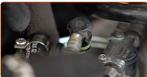
**7** Schrauben Sie das Befestigungselement heraus, das die Kraftstoffversorgungsleitung mit dem Kraftstofffiltergehäuse verbindet. Verwenden Sie einen Kreuzschlitzschraubendreher.
