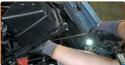
**8** Entfernen Sie das Mikrofasertuch vom Luftansaugschlauch.
