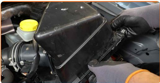
**5** Entfernen Sie das Filterelement von der Luftfilterabdeckung.
