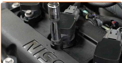
**4** Entfernen Sie die Befestigungsschrauben.
