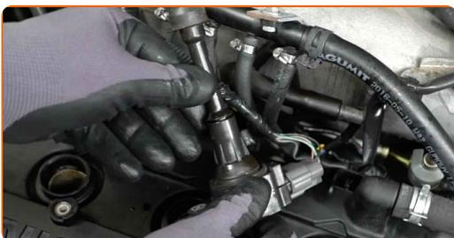
**6** Entfernen Sie Schmutz, Staub und Ablagerungen von den Zündkerzenbohrung.
