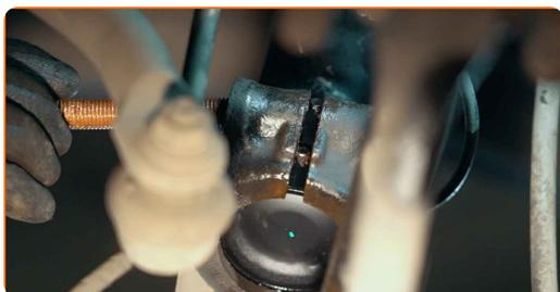
**44** Schrauben Sie das Befestigungselement ein, das das Federbein mit dem Achsschenkel verbindet. Verwenden Sie Ring-Gabelschlüssel Nr. 16. Verwenden Sie Stecknuss Nr. 18. Verwenden Sie einen Ratschenschlüssel.
