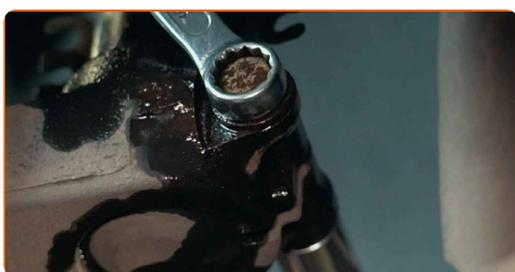
**17** Entfernen Sie die Befestigungsschraube.
