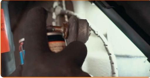
**53** Montieren Sie den Querlenker.
