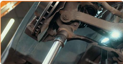
**47** Schrauben Sie das Befestigungselement ein, das den Querlenker mit dem Hilfsrahmen verbindet. Verwenden Sie Ring-Gabelschlüssel Nr. 16. Verwenden Sie Stecknuss Nr. 18. Verwenden Sie einen Ratschenschlüssel.
