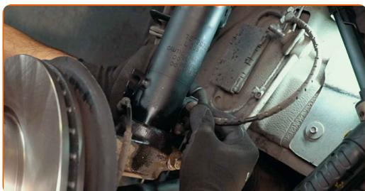
**52** Reinigen Sie die Montagesitze der Koppelstange. Benutzen Sie eine Drahtbürste. Benutzen Sie WD-40-Spray.
