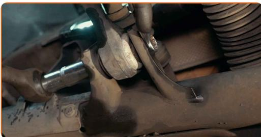
**48** Schrauben Sie die Befestigungen fest, die den Querlenker mit dem Hilfsrahmen verbindet. Verwenden Sie Ring-Gabelschlüssel Nr. 16. Verwenden Sie Stecknuss Nr. 18. Verwenden Sie einen Drehmomentschlüssel. Ziehen Sie ihn mit 110 Nm Drehmoment fest.
