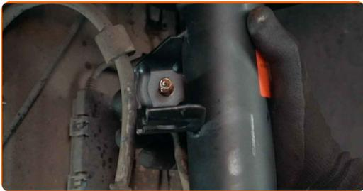
**54** Ziehen Sie das Befestigungselement an, das die Druckstange mit dem Federbein verbindet. Verwenden Sie Stecknuss Nr. 16. Verwenden Sie einen Drehmomentschlüssel. Ziehen Sie ihn mit 65 Nm Drehmoment fest.
