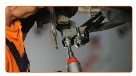
Reinigen Sie das Verbindungselement, welches das Kugelgelenk mit dem Achsschenkel verbindet. Benutzen Sie eine Drahtbürste. Benutzen Sie WD-40-Spray.
