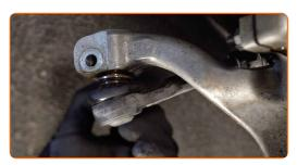
Ziehen Sie die Befestigungsmutter an, die den Spurstangenkopf mit dem Achsschenkel verbindet. Verwenden Sie Stecknuss Nr. 22. Verwenden Sie einen Drehmomentschlüssel. Ziehen Sie ihn mit 80 Nm Drehmoment fest.
