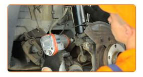
Die Antriebswelle in die Radnabe installieren.
