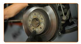
Ziehen Sie die Befestigung der Bremsscheibe fest. Verwenden Sie Inbusschlüssel Nr. H6. Verwenden Sie einen Drehmomentschlüssel. Ziehen Sie ihn mit 9 Nm Drehmoment fest.
