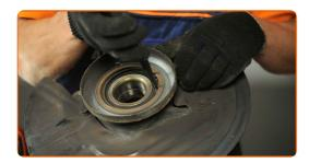
Drücken Sie das Radnabenlager heraus. Verwenden Sie einen Druckstücksatz mit Ein-/Auspresswerkzeug.
