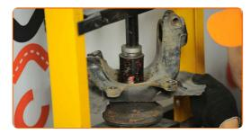
Installieren Sie den Achsschenkel mit einer Nabe.
