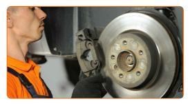
Befestigen Sie die Bremssattelhalterung. Verwenden Sie Stecknuss Nr. 16. Verwenden Sie einen Drehmomentschlüssel. Ziehen Sie ihn mit 110 Nm Drehmoment fest.
