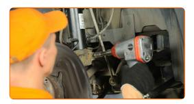
Entfernen Sie die Befestigungsschraube.
