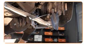
Lösen Sie den vorderen Querlenker vom Achsschenkel. Benutzen Sie einen Hammer.
