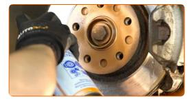
Die Bremsscheibenoberfläche reinigen. Benutzen Sie einen Bremsenreiniger.
