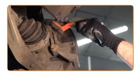
Lösen Sie die Befestigung der Sattelhalterung. Verwenden Sie Stecknuss Nr. 16. Verwenden Sie einen Ratschenschlüssel.
