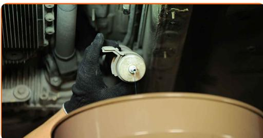
6 Entfernen Sie die Federklemme, die die Kraftstoffleitung fixiert. Verwenden Sie einen flachen Schraubendreher.
