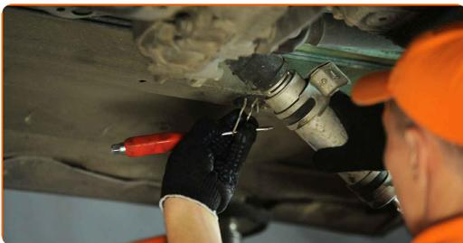
7 Entfernen Sie den Kraftstofffilter.
