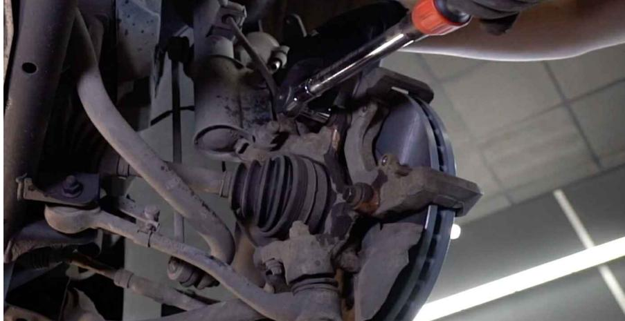
27 Drücken Sie den Bremssattelkolben rein. Verwenden Sie den Bremskolbenrücksteller.
