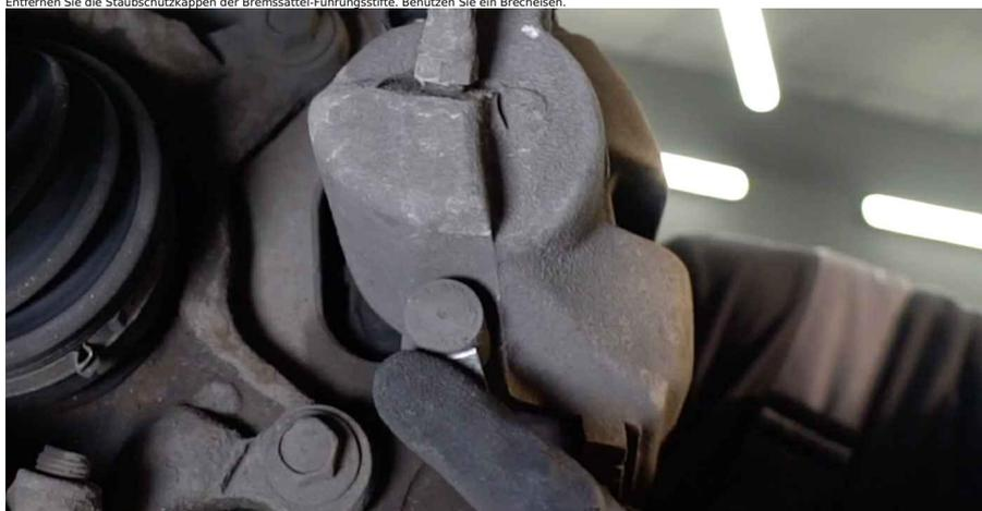
12 Schrauben Sie die Befestigung des Bremssattels ab. Verwenden Sie Inbusschlüssel Nr. H7. Verwenden Sie einen Ratschenschlüssel.
