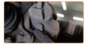
Schrauben Sie die Befestigung des Bremssattels ab. Verwenden Sie Inbusschlüssel Nr. H7. Verwenden Sie einen Ratschenschlüssel.
