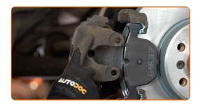
Installieren Sie die Staubschutzkappen der Bremssattel-Führungsstifte.
