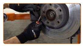
Entfernen Sie den Bremssattel.
