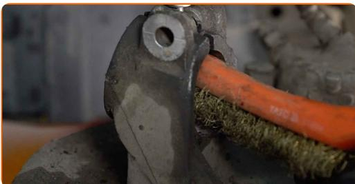
**42** Befestigen Sie das Dämpferbein auf dem Achsschenkel.
