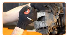
Entfernen Sie den Bremssattel.
