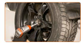
Entfernen Sie den Wagenheber sowie die Unterlegkeile.
