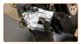
Ziehen Sie das Befestigungselement an, das die Bremsleitung mit dem Bremssattel verbindet. Verwenden Sie einen offenen Ringschlüssel #11. Verwenden Sie einen Drehmomentschlüssel. Ziehen Sie ihn mit 40 Nm Drehmoment fest.
