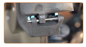
Schmieren Sie die Führungsstifte mit Spezialbremsfett ein.
