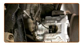
Installieren Sie die Staubschutzkappen der Bremssattel-Führungsstifte.
