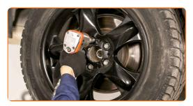
Senken Sie das Auto und ziehen Sie die Radschrauben über Kreuz an. Verwenden Sie eine Schlagnuss für Felgen # 17. Verwenden Sie einen Drehmomentschlüssel. Ziehen Sie ihn mit 140 Nm Drehmoment fest.
