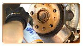
Die Bremsscheibenoberfläche reinigen. Benutzen Sie einen Bremsenreiniger.
