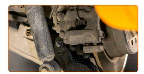
Reinigen Sie den Bereich, in welchem der Bremsschlauch an den Bremssattel angeschlossen ist, sowie den Bereich der Führungsbolzen. Benutzen Sie einen Bremsenreiniger.
