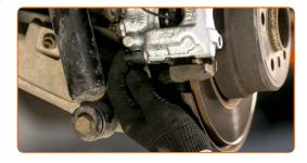
Bauen Sie die Bremssattel-Haltefeder ein. Verwenden Sie einen flachen Schraubendreher.
