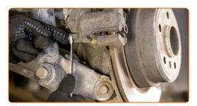
Entfernen Sie die Führungsstifte aus dem Bremssattel.
