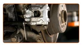
Reinigen Sie die Bremssattel-Führungsstifte.
