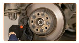
Trennen Sie das Bremsbelagverschleißkabel ab.
