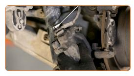
Trennen Sie den Bremsschlauch.
