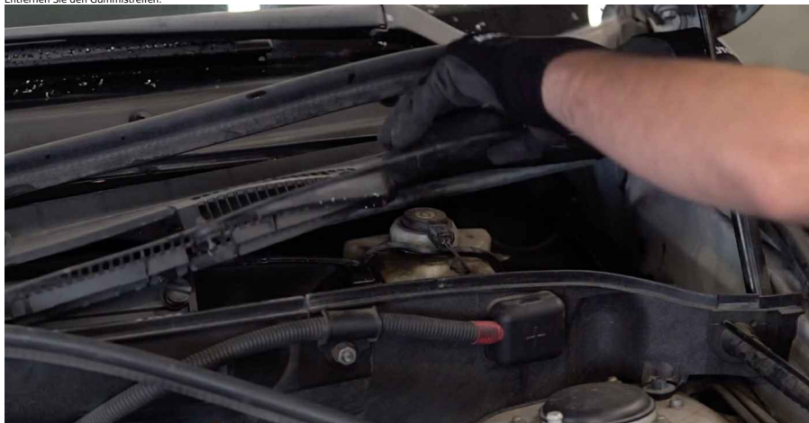
4 Schrauben Sie die Kappe des Bremsflüssigkeitsausgleichsbehälters ab.
