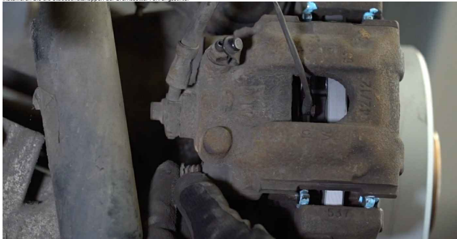
24 Bauen Sie die Bremssattel-Halterfeder ein.
