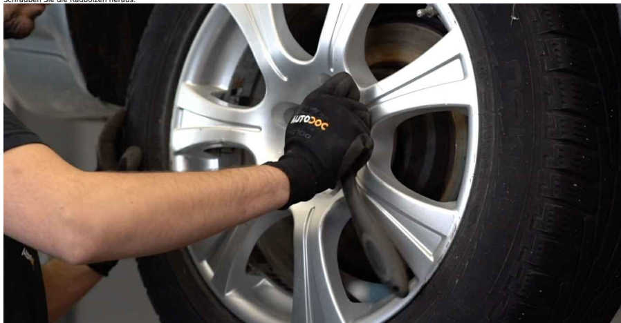
8 Schrauben Sie die Radbolzen heraus.
