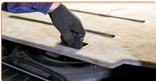
**15** Schrauben Sie die Befestigungsschrauben der Schutzabdeckung ab. Verwenden Sie Stecknuss Nr. 10. Verwenden Sie einen Ratschenschlüssel.
