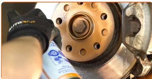
**51** Die Bremsscheibenoberfläche reinigen. Benutzen Sie einen Bremsenreiniger.
