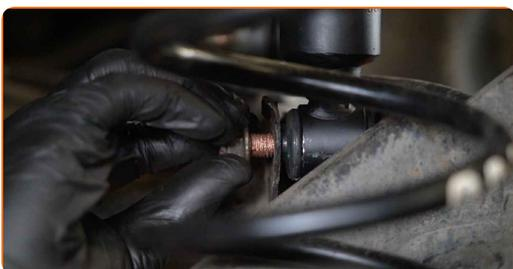
**47** Ziehen Sie den unteren Befestiger des Stoßdämpfers an. Verwenden Sie Ring-Gabelschlüssel Nr. 21. Verwenden Sie Stecknuss Nr. 21. Verwenden Sie einen Drehmomentschlüssel. Ziehen Sie ihn mit 127 Nm Drehmoment fest.
