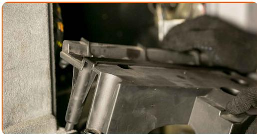
**39** Ziehen Sie die Befestigungsschrauben der Schutzabdeckung fest. Verwenden Sie Stecknuss Nr. 10. Verwenden Sie einen Ratschenschlüssel.
