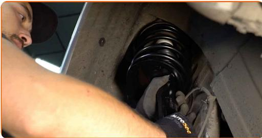
**53** Schrauben Sie die obere Befestigung des Domlagers an. Schrauben Sie diese nicht fest.
