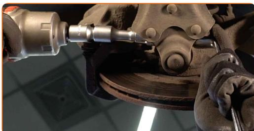
**25** Entfernen Sie die Befestigungsschraube. Verwenden Sie einen Splintentreiber. Benutzen Sie einen Hammer.
