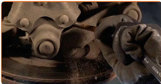
**26** Trennen Sie das Kugelgelenk vom Achsschenkel. Benutzen Sie ein Brecheisen.
