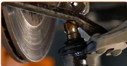
**27** Entfernen Sie die Antriebswelle. Verwenden Sie einen Splintentreiber. Benutzen Sie einen Hammer.
