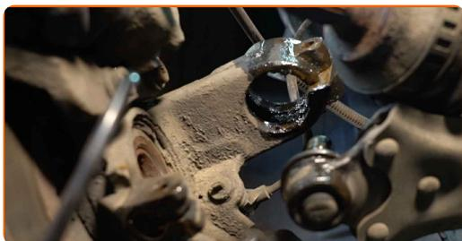
**34** Lösen Sie die obere Befestigung des Domlagers. Verwenden Sie Stecknuss Nr. 14.
