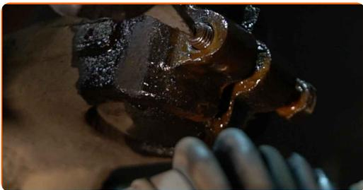
**31** Lösen Sie das untere Befestigungselement, dass das Federbein mit dem Achsschenkel verbindet. Verwenden Sie einen flachen Metallmeißel. Benutzen Sie einen Hammer.
