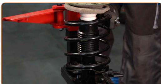
**51** Entfernen Sie das zusammengebaute Federbein.
