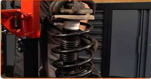
**52** Installieren Sie das Federbein am Radlauf.
